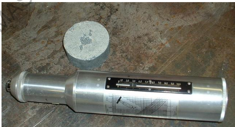
Figura 413 - 1. Martillo de rebote y piedra abrasiva
