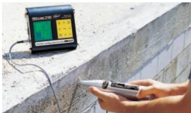
Figura 413 - 4. Ensayo con el esclerómetro
