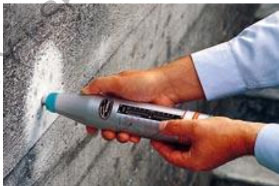
Figura 413 - 3. Superficie pulida y ensayo con el esclerómetro
